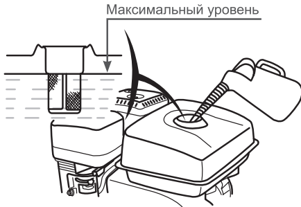
Рис. 13 Максимальный уровень топлива в топливном баке
