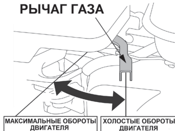
Рис. 20 Положения рычага газа
