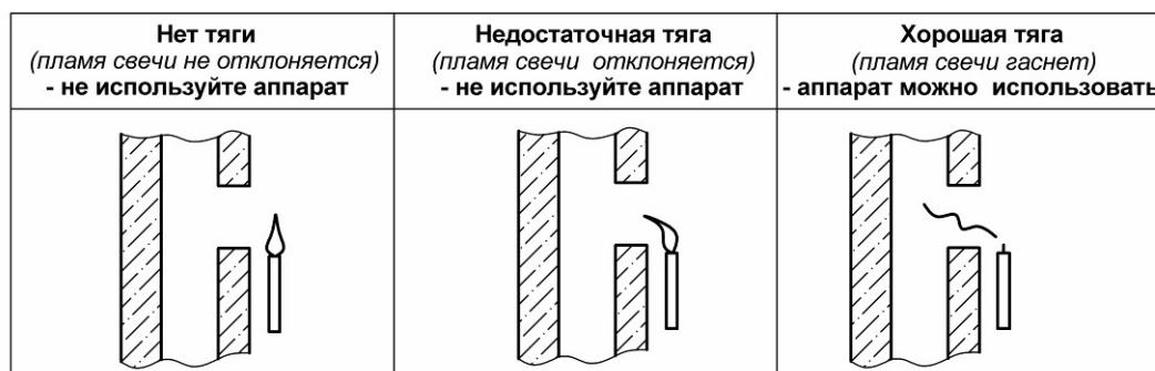
Рисунок 3. Простейший способ проверки тяги в дымоходе
