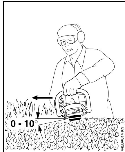
Режущие ножи установите под углом от  $0^{\circ}$  до  $10^{\circ}$  – но направляйте горизонтально.
