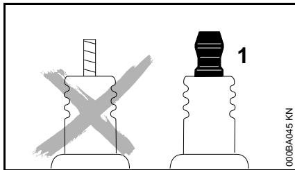
У свечи зажигания с отдельной соединительной гайкой
