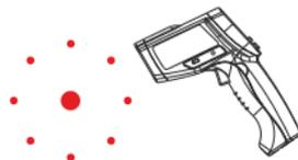
Диаметр круга приблизительно соответствует диаметру пятна измерения.
