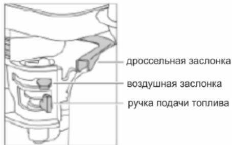
1. При запуске холодного двигателя установите заслонку в положение ВКЛ, передвинув рычаг заслонки полностью влево. При запуске теплого двигателя перемещение заслонки обычно не требуется.
