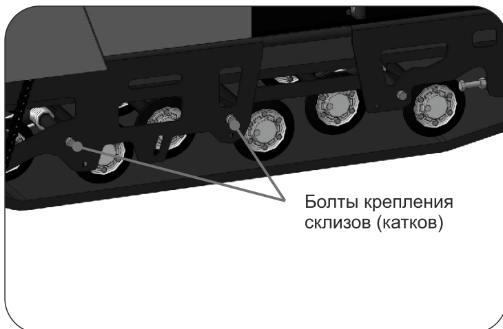
Рис. 8. Регулировка угла «атаки» МБС 3.
