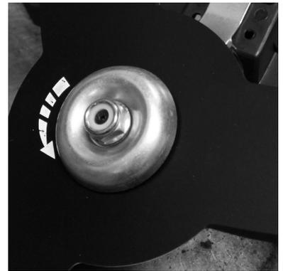
Крепление режущего диска: совместите отверстие в ступице вала с отверстием в чашке редуктора.
