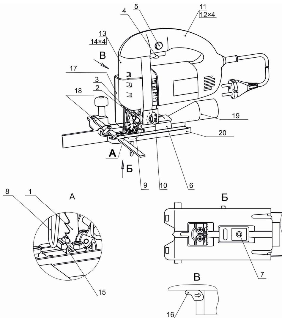
1 - пи́лка; 2 - винт; 3 - скоба; 4 - клавиша выключателя; 5 - фиксатор; 6 - опора; 7 - винт; 8 - скоба защитная; 9 - ролик; 10 - рукоятка; 11 - ручка; 12 - винт; 13 - крышка; 14 - винт; 15 - вкладыш; 16 - заслонка; 17 - кожух; 18 - линейка; 19 - патрубок; 20 - накладка.
