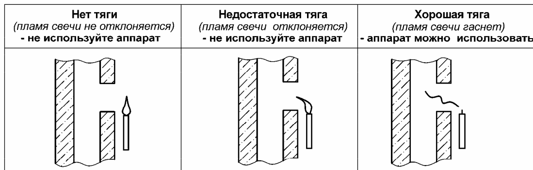
Рисунок 4. Способ проверки тяги в дымоходе
