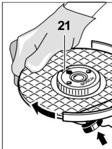
Для фиксации шлифовального шпинделя нажмите кнопку блокировки 2. Для затягивания быстрозажимной гайки поверните шлифовальный круг с усилием по часовой стрелке.
