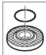
В посадочный фланец **7** вставлена вокруг буртика центрирования пластмассовая деталь (круглое кольцо). Если кольцо отсутствует или повреждено, то его следует обязательно установить или заменить (товарный №
