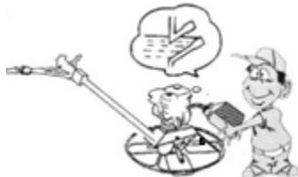
Проверьте трансмиссионное масло в редукторе. Добавьте при необходимости трансмиссионное масло в редуктор машины, проверяйте уровень трансмиссионного масла каждые 50 часов, проверяйте качество масла и заменяйте масло в машине по мере необходимости. Рекомендуемое нами масло марки CLP-320.
