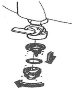
Снятие фильтрующего элемента топливного фильтра
