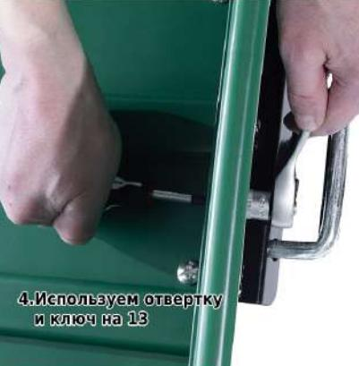
4. Используем отвертку и ключ на 13
