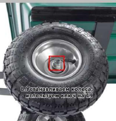
8. Устанавливаем колеса, используем ключ на 19
