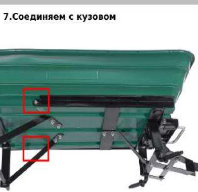
7. Соединяем с кузовом
