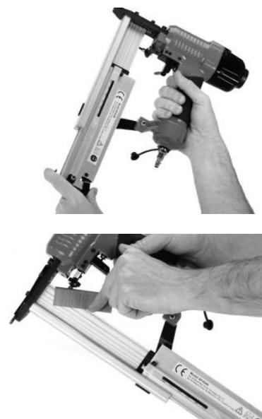
Ручка регулировки глубины прикреплена к носику для установки глубины гвоздя / скобки.
