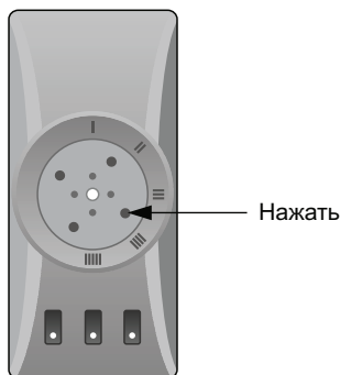
Рис. 3. Расположение штока на термовыключателе термостата.
