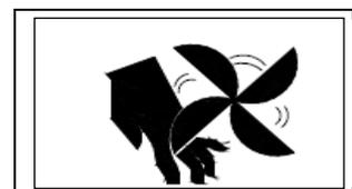
5. Регулярно удаляйте пыль с помощью чистого и сухого сжатого воздуха; если оборудование находится в сильно загазованной и загрязненной атмосфере, то его чистка должна производиться ежемесячно.
