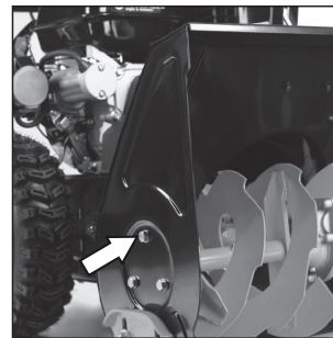
Шаг 10. Проверьте затяжку болтов опорных подшипников шнека.
