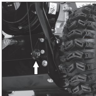
Шаг 9. Проверьте установку троса привода колес с роликом.
