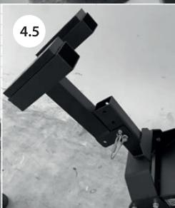
6. Вставьте в сцепное устройство дышло для фаркопа и закрепите его двумя болтами с гайками.
