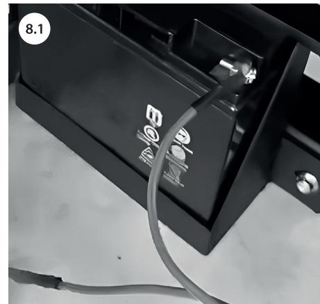
**ВНИМАНИЕ!** При подключении проводов к аккумулятору всегда сначала подсоединяется клемма "+"(плюс) и лишь затем клемма "−"(минус). Отключение аккумулятора производится в обратном порядке: сначала Минус, а затем Плюс.
