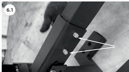
5. Далее, через прокладку на четыре болта фиксируется разгрузочный желоб.
