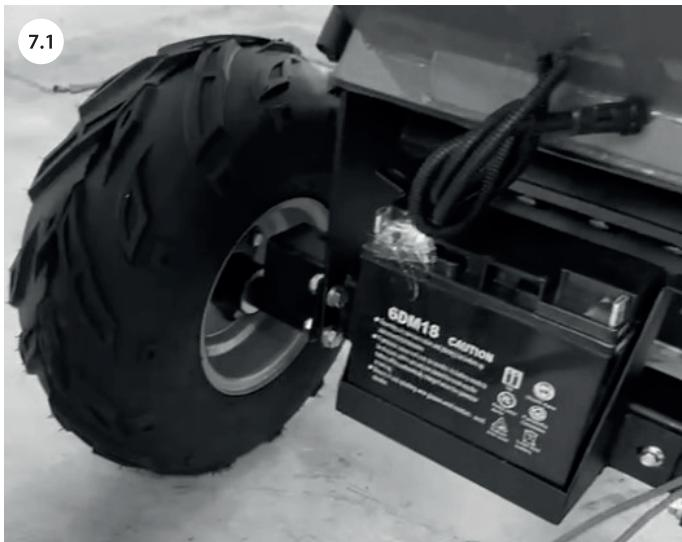
8. Подключите клемы проводов питания к аккумулятору. Кабель красного цвета крепится к клемме «+».
