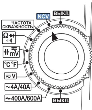
*Срабатывание зависит от многих факторов в т.ч. толщина изоляции проводника, расстояние до проводника, влажность воздуха и т.д. Поэтому отсутствие срабатывания НЕ даёт 100% гарантии отсутствия напряжения, кроме этого проверка в многожильном кабеле не даёт достоверных результатов.*
