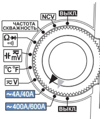
Установите поворотный переключатель в положение « $\sim 4\text{A}/40\text{A}$ » или « $\sim 400\text{A}/600\text{A}$ ». На дисплее отобразится символ « $\sim \text{A}$ ». Нажмите курок, чтобы открыть токовый датчик, закрепите датчик на фазном проводе (провод должен располагаться как можно ближе к центру датчика), отпустите курок. На дисплее будет отображено значение переменного тока.
