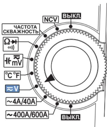
Поверните поворотный переключатель в положение « $\text{~V}$ ». В верхней части дисплея появится символ « $V$ », а в левой части дисплея « $=$ ». Вставьте черный щуп в гнездо «COM», а красный в гнездо « $V/\Omega$ ». Подключите щупы к измеряемой цепи, и на дисплее будет отображено значение измеренного напряжения. Если дисплей показывает значок «OL», то измеряемое напряжение превышает 660В.
