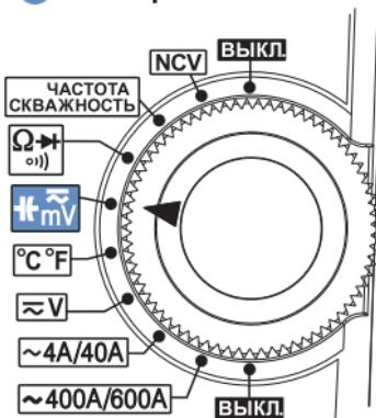
*Внимание! При измерении ёмкости необходимо обеспечить разрядку измеряемого конденсатора.*
