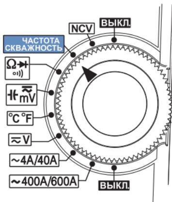
Установите поворотный переключатель в положение «ЧАСТОТА/СКВАЖНОСТЬ». На дисплее появится символ «Hz». Вставьте красный щуп в гнездо «V/Ω», а черный в гнездо «COM». Подключите щупы к измеряемой цепи – на дисплее отобразится значение измеренной частоты.
