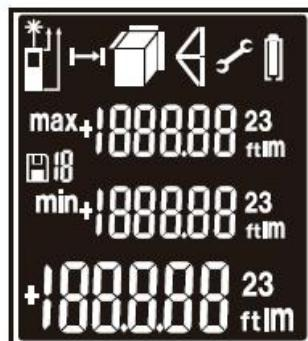
Затем измеритель входит в режим однократного измерения, и включается лазер, изображение на дисплее, как показано на рисунке А. Лазер автоматически отключается, если в течение 30 секунд не выполняется никаких действий. Нажмите , чтобы выключить лазер, появится изображение, как показано на рисунке В. Снова нажмите , чтобы включить лазер, появится изображение, как показано на рисунке С.
