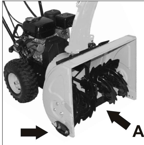
Перед началом работы необходимо отрегулировать опорные лапы. Для предотвращения поломки шнека высоту опорных лап регулируют так, чтобы пластина А находилась над грунтом не менее 1см.
