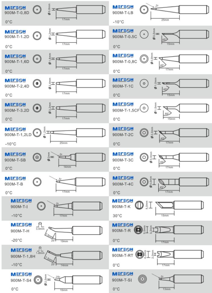
**Обратите внимание!!! При установке различных наконечников, необходима коррекция температуры, это связано с различной формой, сечением и размером наконечника. Например наконечник МЕГЕОН 900M-T-0,8D имеет корректирующее значение 0 °C – соответственно его температура будет равна установленной, а при использовании наконечника МЕГЕОН 900M-T-K имеющего коэффициент +30°C – необходимо устанавливать на 30 °C меньше. В таблице**
