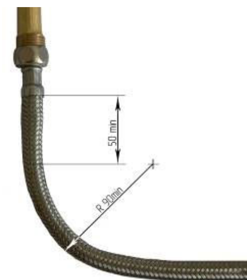
Рисунок 5 Требования к монтажу гибких шлангов
