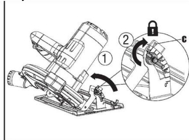
**ПРИМЕЧАНИЕ!** При пилении под наклоном значение глубины пропила, устанавливаемое по шкале, не совпадает с истинным значением. Глубина пропила в этом случае равна перпендикуляру от вершины самого низкого зуба к плоскости платформы.
