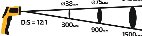
**Расстояние и размер пятна, на котором измеряется температура.**
