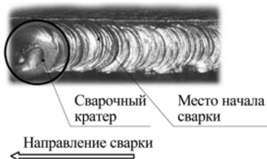
Рис. 9.4. Начало сварки при смене электрода.
