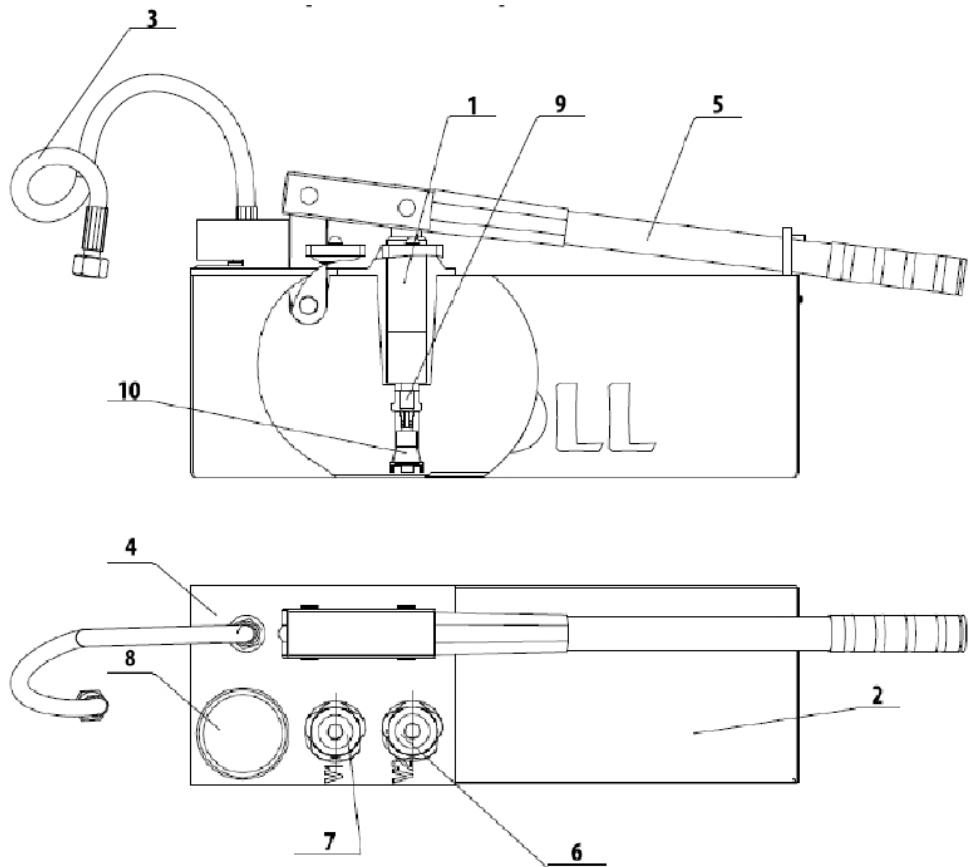
1-насос, 2-бак, 3-шланг высокого давления 4-плита, 5-рукоятка, 6 - вентиль V2, 7-вентиль V1,
