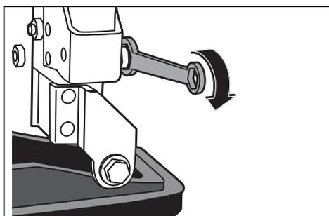
Вставить нижнюю часть опорной трубы через зажим, в нижнее крепление. Временно оставьте зажим свободным. Прикрепите нижнюю часть опорной трубы к креплению болтами. Хорошо затяните, когда сборка будет завершена полностью.
