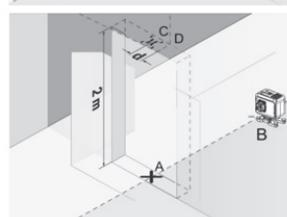
Повторите вышеописанную процедуру для второй вертикальной плоскости. Максимально допустимое отклонение высчитывается по формуле: высота проёма  $x 2 \times 0,2$  мм/м.
