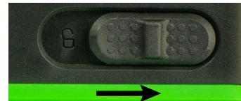
При включении прозвучит звуковой сигнал и загорятся все лучи. После загрузки будет активирована горизонтальная линия. Также будет активирована звуковая и световая сигнализации при выходе механизма самовыравнивания из диапазона. При наклоне прибора более 3° в любую из сторон сигнализация будет активирована. Для отключения функции необходимо удерживать кнопку **(ON)** или **(OUT)** на пульте в нажатом состоянии около 3-х секунд. Для активации функции необходимо повторить действие.
