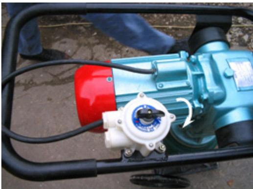
Для запуска вибротрамбовки поверните выключатель по часовой стрелке – вибротрамбовка начинает движение.
