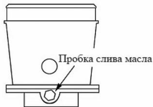
Слева – расположение сливного отверстия масла для восьмигранной нижней опоры пылезащитного кожуха.
