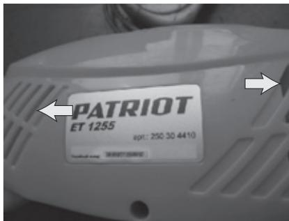
При загрязнении охлаждающих отверстий продуктами покоса используйте для очистки кисточку и/или баллон со сжатым воздухом.
