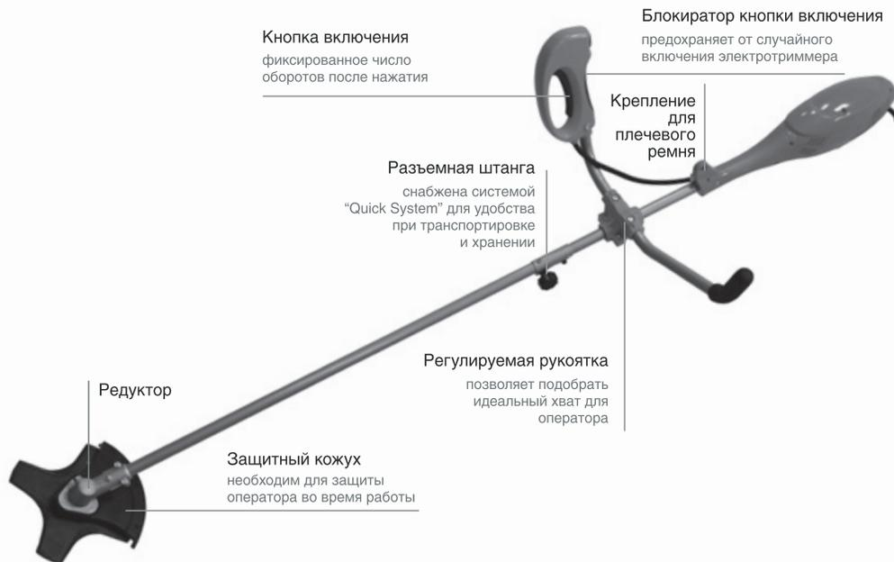
КОНСТРУКЦИЯ ТРИММЕРА МОЖЕТ ОТЛИЧАТЬСЯ ОТ ПРЕДСТАВЛЕННОЙ В ИНСТРУКЦИИ
