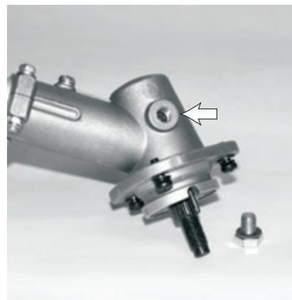
Раз в три месяца проверяйте наличие смазки в редукторе. При необходимости надо сменить смазку или обратиться в авторизованный сервисный центр. Для смазки редуктора можно использовать оригинальную графитовую смазку Arsenal компании Patriot.
