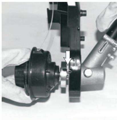
После окончания работ разберите триммерную головку и очистите ее от остатков скошенной травы. Вал редуктора смажьте графитовой или литиевой смазкой.
