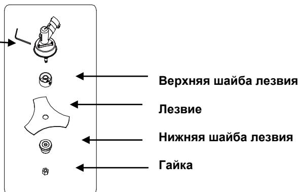
Открутите гайку по часовой стрелке (в правую сторону) и снимите нижнюю шайбу лезвия.
