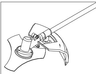
Защитный кожух должен крепиться к опорной части, возле редуктора при помощи четырёх винтов и двух пластин.
