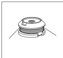
Прикрутите нейлоновую катушку против часовой стрелки (в левую сторону) по резьбе на выходном валу редуктора. Зафиксируйте шток на месте, вставив отвёртку или ключ-шестигранник в отверстие в верхнем зажиме катушки и крепко затяните ее.
