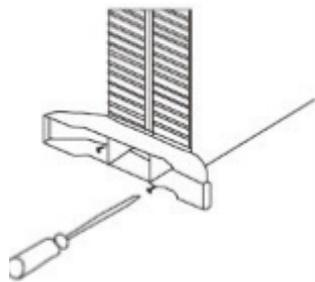
Перед использованием обогревателя опора (поставляемая отдельно в коробке) должна быть прикреплена к прибору. Для крепления опоры к основанию обогревателя используются 4 предоставленных в комплекте винта-самореза, при этом необходимо соблюдать осторожность, чтобы обеспечить их правильное расположение в нижней части боковых фасонных планок обогревателя.
