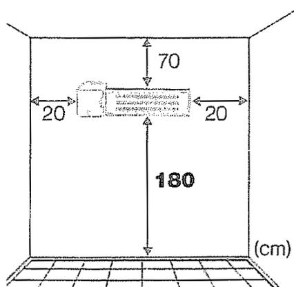
При установке IWQ должны соблюдаться минимальные расстояния от обогревателя до потолка, пола, а также поверхностей и предметов, находящихся слева и справа от обогревателя, как показано на рисунке.
