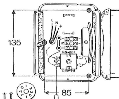
Просверлите отверстия и прикрепите прибор к стене при помощи винтов и дюбелей, входящих в комплект поставки.
