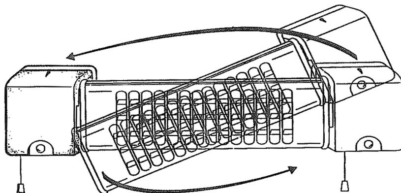
Если блок управления необходимо расположить с левой стороны, переключательный элемент должен быть вынут из посадочного места при помощи отвертки, развернут на 180° и установлен на новое посадочное место, соответствующее левому расположению блока управления. Убедитесь в том, чтобы переключательный элемент был четко зафиксирован зажимами в месте посадки.
