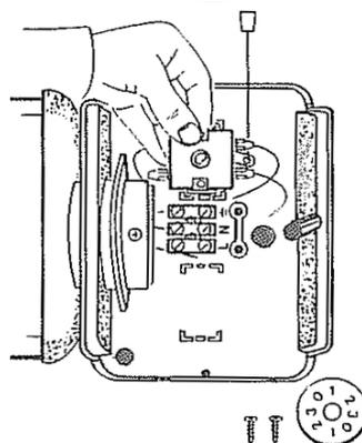
Протяните электрический провод через входное отверстие в блоке управления прибора и наметьте места для отверстий крепежных винтов.
