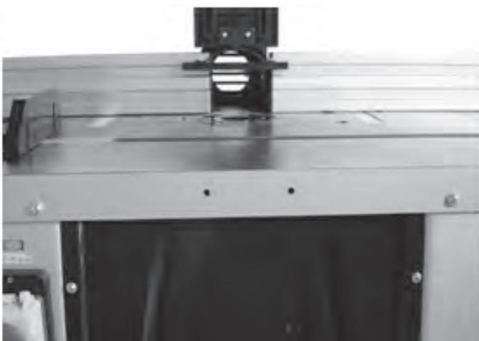
Разместите крепление бокового упора так, чтобы крепежные отверстия на нем и на рабочем столе совпали и закрепите при помощи болтов.
