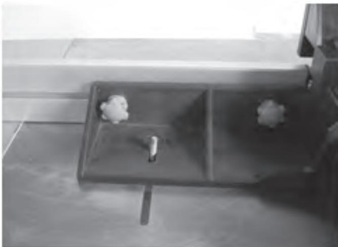
Разместите упор на столе так, чтобы отверстия на упоре совпали с отверстиями на рабочем столе. Вставьте часть Б в специальный паз на части А.
