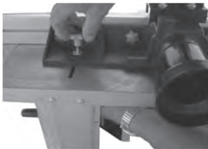
Затем с внутренней стороны стола вставьте в отверстия болты и затяните при помощи барашковых гаек с шайбами.
