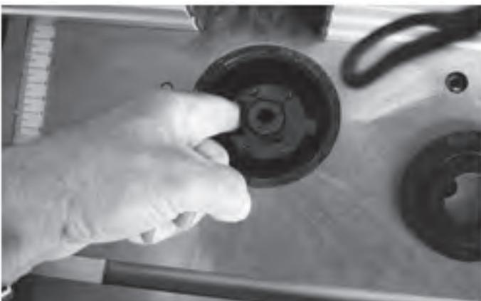
Удерживая шпиндель в застопоренном состоянии, открутите гайку крепления патрона при помощи ключа, входящего в комплект и извлеките патрон.
