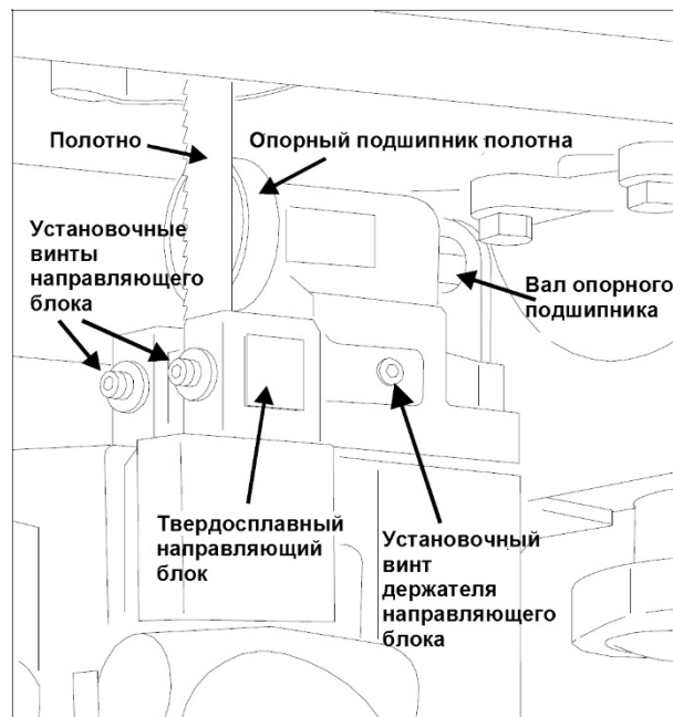
Рисунок 14. Нижний опорный узел полотна.
