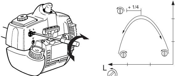
**ВНИМАНИЕ!** Если режущее оборудование вращается или подвижно при работе на холостых оборотах, винт **T** следует вращать против часовой стрелки до тех пор, пока режущее оборудование не остановится.
