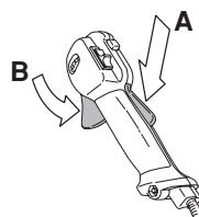
Проверьте, чтобы ручка газа в момент возвращения блокировочного рычага в исходное положение была блокирована на холостом ходу.
