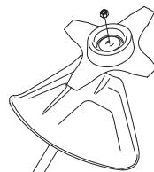
При сборке надо затягивать гайку против направления вращения режущего оборудования. При разборке надо отвинчивать гайку в направлении вращения режущего оборудования. (ЗАМЕЧАНИЕ! Гайка имеет левостороннюю резьбу.) Затягивать гайку следует торцевым ключом.
