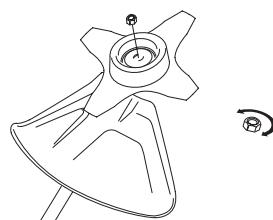
При ослаблении и затягивании гайки лезвия для пиления, рука может быть травмирована зубьями лезвия. Старайтесь, чтобы при этой работе ваша рука всегда была защищена щитком лезвия. Эта задача облегчается за счет использования длинного торцового ключа. На иллюстрации стрелкой показан участок, в котором следует располагать торцовый ключ при ослаблении и затягивании гайки.
