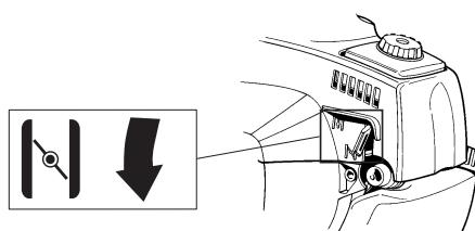
**ПРЕДУПРЕЖДЕНИЕ!** При запуске двигателя с включенным подсосом или в положении пуска, режущее оборудование начинает сразу же вращаться.
