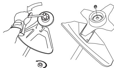
Нейлоновая прокладка контргайки не должна быть изношена настолько, чтобы ее можно было поворачивать вручную. Прокладка должна выдерживать усилие минимум 1,5 Нм. Гайку следует заменить после ее использования приблизительно 10 раз.
