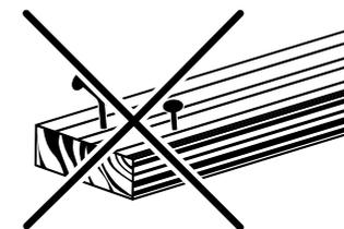
Перед началом работы убедитесь в отсутствии в заготовке металлических предметов (шурупов, гвоздей).
