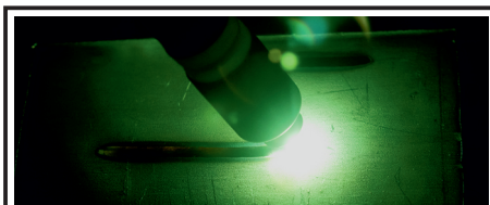
Что видит сварщик через обычный светофильтр.
