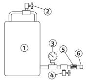
Подсоедините к насосу всасывающий и обратный шланги. На всасывающий шланг установите фильтры грубой и тонкой очистки (если жидкость для испытания чистая без взвеси и осадка - достаточно только фильтра тонкой очистки). Опустите их в ёмкость с жидкостью для испытаний.
