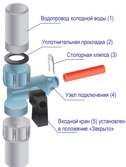
Рис. 3. Схема установки узла подключения
