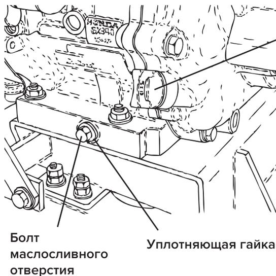
Колпачок маслозаливного отверстия
