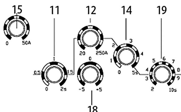
**19. Таймер подачи газа после сварки.** После сварки необходимо защищать поверхность сварочного шва и вольфрамового электрода во избежание их окисления.
