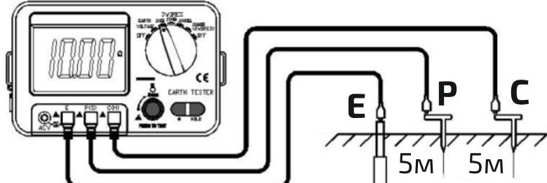
Включите прибор, переведя переключатель (2) в положение «3 WIRES – 2000  $\Omega$ » и нажмите кнопку **ИЗМЕРЕНИЕ**.
