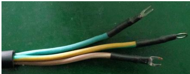
3 провода силового кабеля: коричневый, синий и желто-зеленый.
