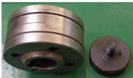
Отвернутый стопор опорного ролика и сам опорный ролик
