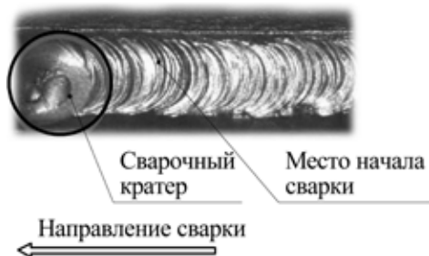
Рис. 8.4. Начало сварки при смене электрода.
