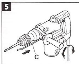
Ослабьте крепление рукоятки и вставьте прямую часть ограничителя глубины в установочное отверстие. Установите требуемую глубину сверления. Закрепите крепление ручки
